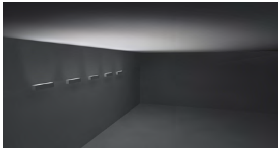
U 型配光 灯具间距 0.5m，距天花 1m 高度光学模拟
