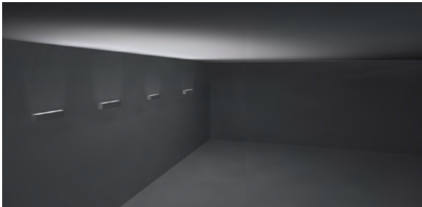
W 型配光 灯具间距 0.7m，距天花 1m 高度光学模拟
