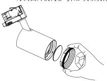
如上图将用手将前盖顺时针旋转,旋转到转不动时, 用手将前盖从灯上取出,取出玻璃配件,即可将新的 玻璃装入灯具。
