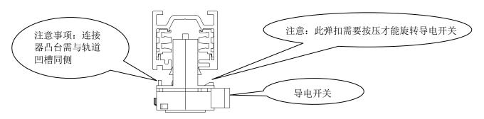
3. 装配完成后将"导电开关"顺时针旋转90度进行导通。
