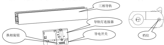
2. 装配前将导轨灯连接器的凸台对准导轨的凹槽。
