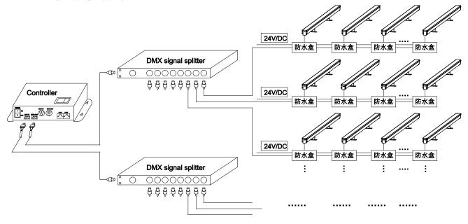
备注:导线连接须使用 IP65 及以上等级防水接线盒,接线盒的防水接头须和灯具引线相匹配,建议每一电源回路 所接灯具拼接总长不超过 15 米。
