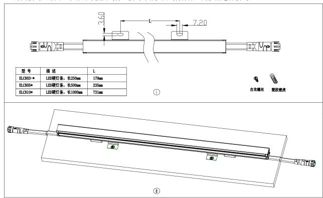
ON-OFF 版本: 公母端接头上有电源线标贴, 棕色为正极; 蓝色为负极; DMX512 调光版本: 公端接头上有输入标贴, 母端接头上有输出标贴;
