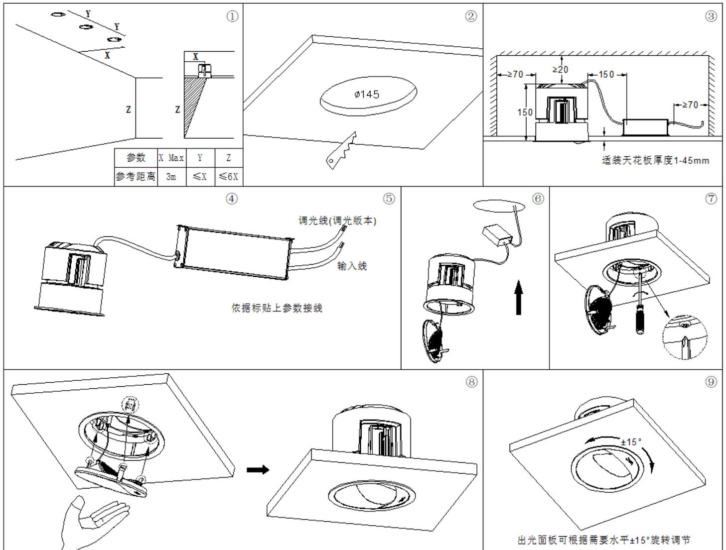
说明：依据**电源线输入标贴**上电压要求接好线；如有调光版本，请注意调光线+/-极，不要接错。
