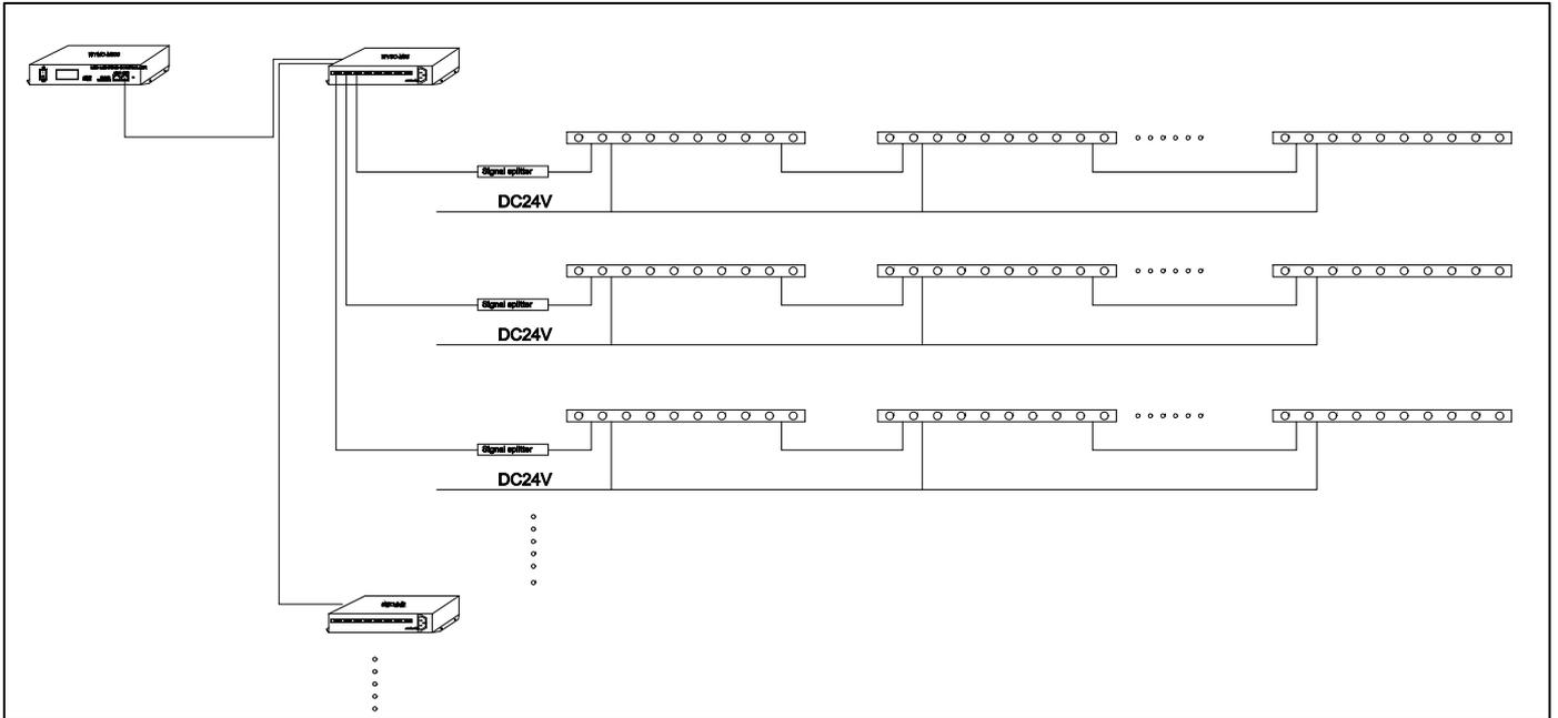
备注：导线连接须使用 IP65 及以上等级防水接线盒，接线盒的防水接头须和灯具引线相匹配，建议每一个 DMX 信号放大器所载灯具不超过 32 盏为宜。
